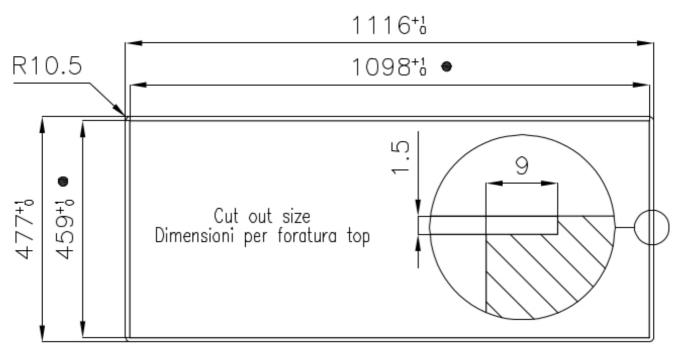
● Built—in cut out for FTS — Foratura per installazione FTS
